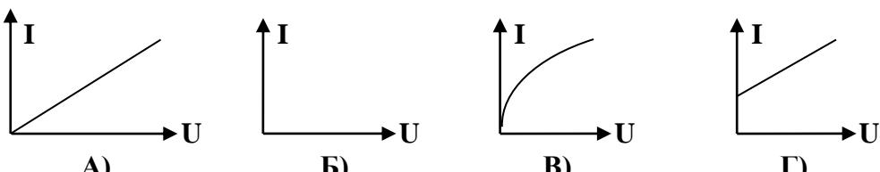
19. Какой из графиков представляет собой вольт-амперную характеристику полупроводникового диода?
